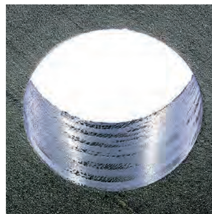
Отверстие D = 6,35 мм не направленные CFK с оптимальным качеством обработки
