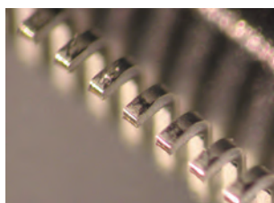
Пример измерения : высота пиков на QFP-корпусе
