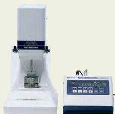
Моторизованный прибор LITEMATIC для высокоточных измерений с малым усилием
