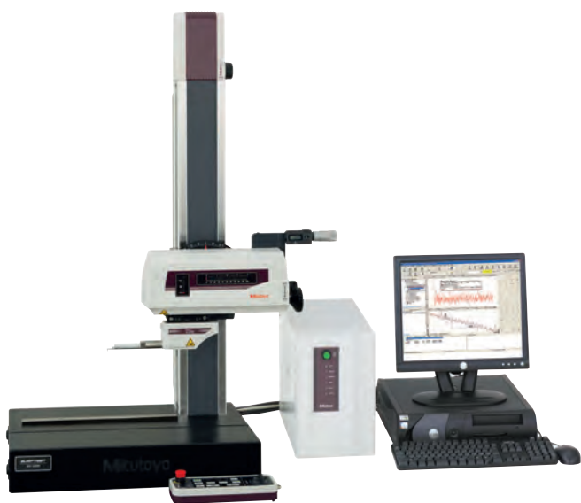
SV-3200H4 с опциональным блоком наклона DAT
