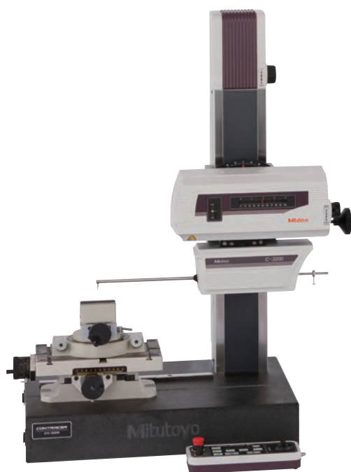
Контурограф CV-3200 (CV-4500 оборудован двусторонним щупом)
