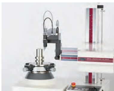
Измерение/анализ по спирали (RA-1600)
