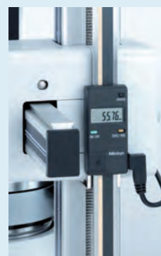
Линейная шкала по оси Z
