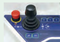
Панель управления для быстрого перемещения и позиционирования по трем координатам
